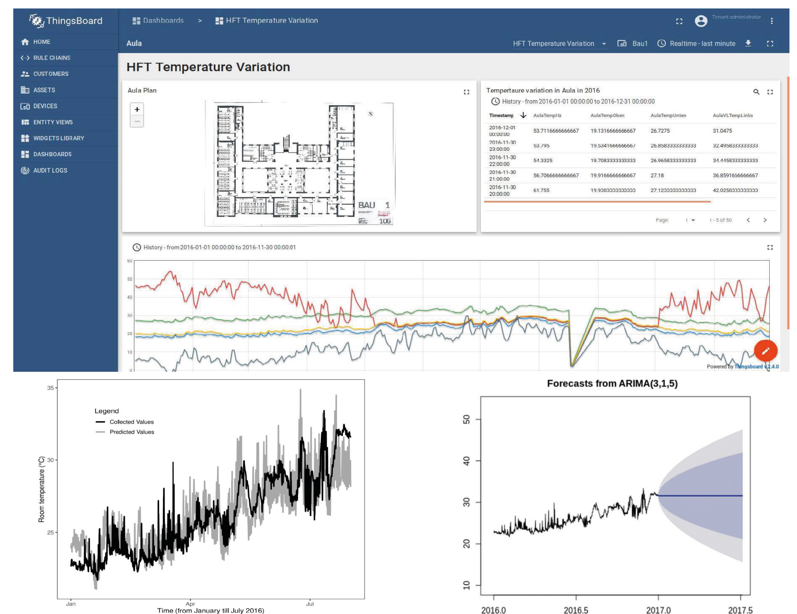
Abb. 2: Oben: Raumplan-Ansicht, Sensorauswahl und Zeitverläufe im Dashboard dargestellt. Unten Links: Temperaturverlauf Vorhersage und gemessener Wert. Unten Rechts: zeitliche Fehlerentwicklung.
